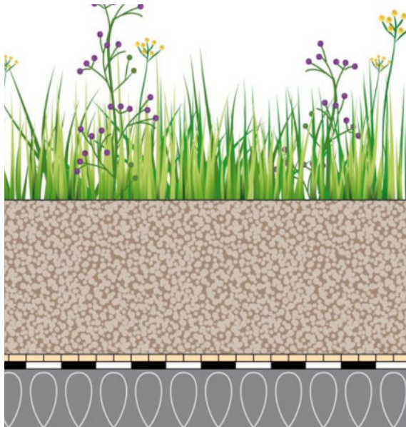
Abb. 3 Einschichtiger Gründachaufbau (BuGG)
