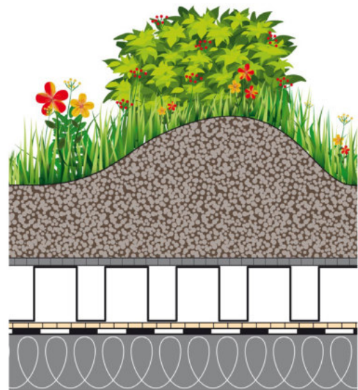
Abb. 18 Schnitt Biodiversitätsgründach (BuGG)
