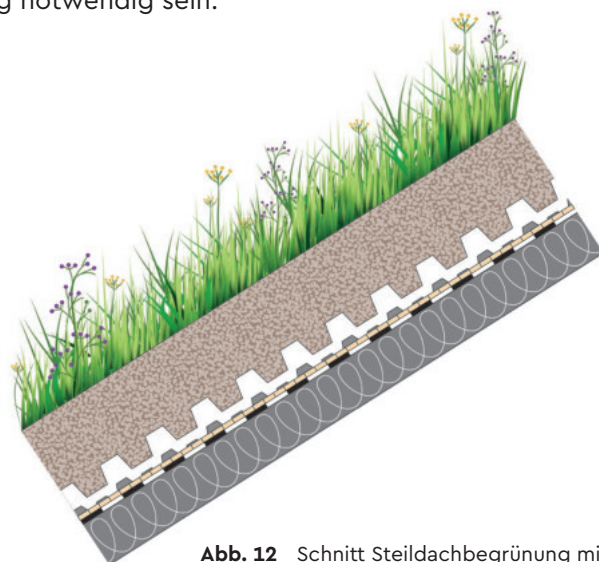
Abb. 12 Schnitt Steildachbegrünung mit Rutschsicherung (BuGG)
