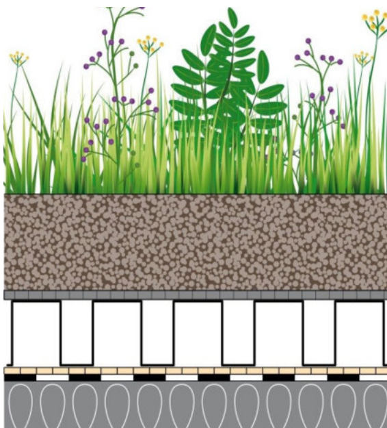
Abb. 2 Mehrschichtiger Gründachaufbau (BUGG)
