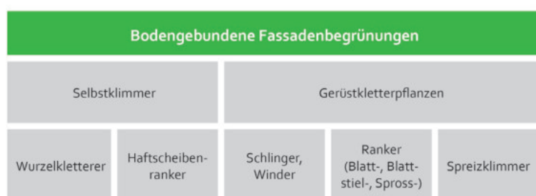
Abb. 33 Übersicht bodengebundene Fassadenbegrünung (BuGG)
